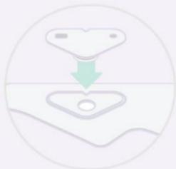
Přestaňte zařízení používat umístěním čidla na základní stanici a nabijte čidlo. Vypnou se tak všechna oznamení, dokud nebude čidlo vyjmuto ze základní stanice.
